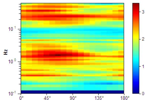
**Picco H/V a  $0.28 \pm 0.13$  Hz (nell'intervallo 0.0 - 20.0 Hz).**
