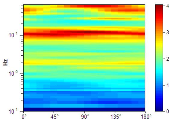
**Picco H/V a  $10.81 \pm 0.73$  Hz (nell'intervallo 0.0 - 20.0 Hz).**
