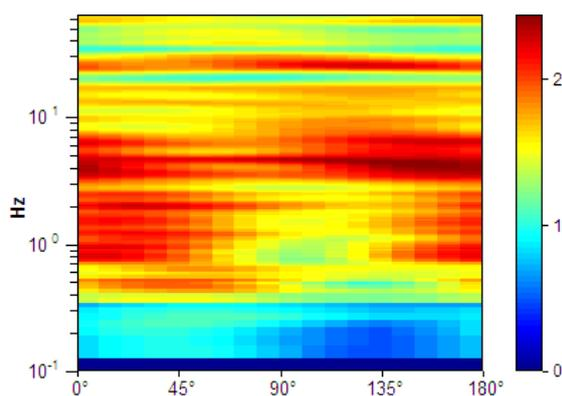
**Picco H/V a  $4.5 \pm 0.97$  Hz (nell'intervallo 0.0 - 20.0 Hz).**
