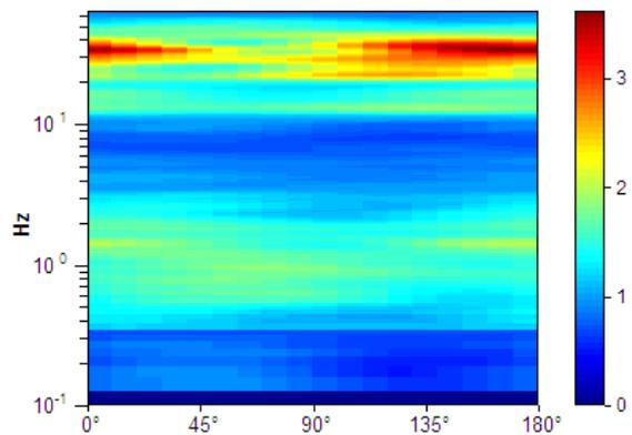
**Picco H/V a  $1.19 \pm 2.93$  Hz (nell'intervallo 0.0 - 20.0 Hz).**
