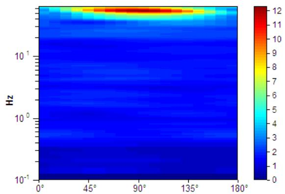
**Picco H/V a  $4.22 \pm 0.82$  Hz (nell'intervallo 0.0 - 15.0 Hz).**
