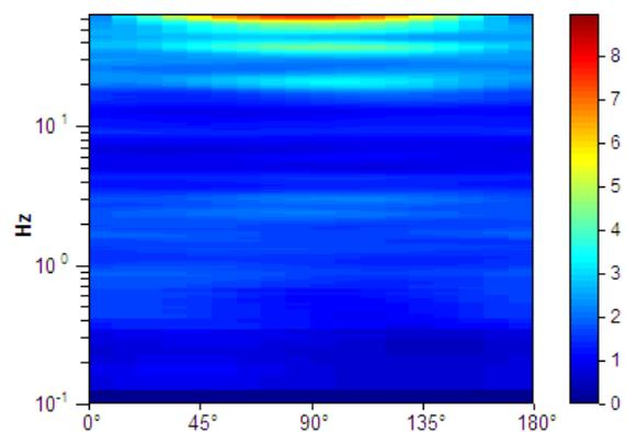
**Picco H/V a  $2.28 \pm 0.3$  Hz (nell'intervallo 0.0 - 15.0 Hz).**
