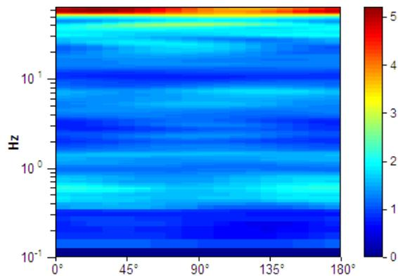
**Picco H/V a  $0.56 \pm 0.04$  Hz (nell'intervallo 0.0 - 20.0 Hz).**
