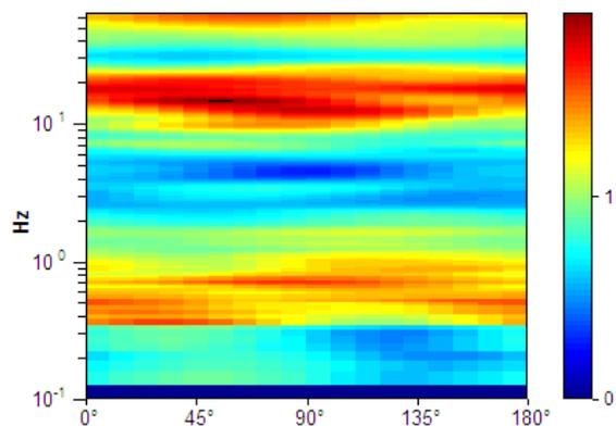
**Picco H/V a  $17.66 \pm 3.09$  Hz (nell'intervallo 0.0 - 20.0 Hz).**
