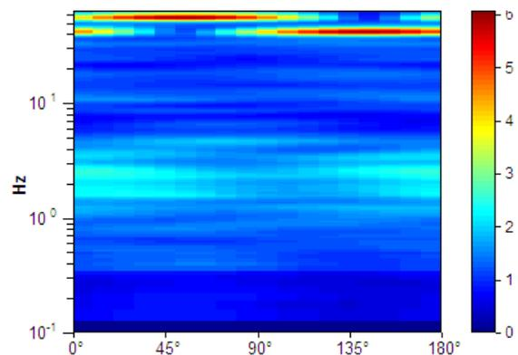
**Picco H/V a  $2.38 \pm 0.11$  Hz (nell'intervallo 0.0 - 20.0 Hz).**
