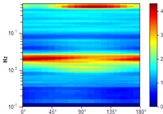
**Picco H/V a  $2.0 \pm 0.08$  Hz (nell'intervallo 0.0 - 20.0 Hz).**
