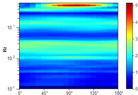
**Picco H/V a  $2.75 \pm 0.18$  Hz (nell'intervallo 0.0 - 20.0 Hz).**
