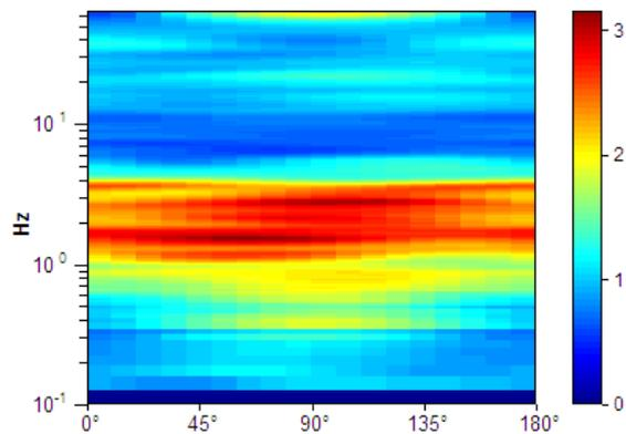
**Picco H/V a  $1.53 \pm 0.14$  Hz (nell'intervallo 0.0 - 20.0 Hz).**
