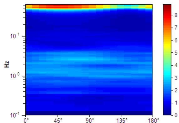
**Picco H/V a  $1.22 \pm 0.06$  Hz (nell'intervallo 0.0 - 20.0 Hz).**
