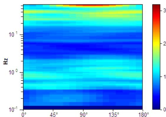
**Picco H/V a  $0.81 \pm 0.09$  Hz (nell'intervallo 0.0 - 20.0 Hz).**
