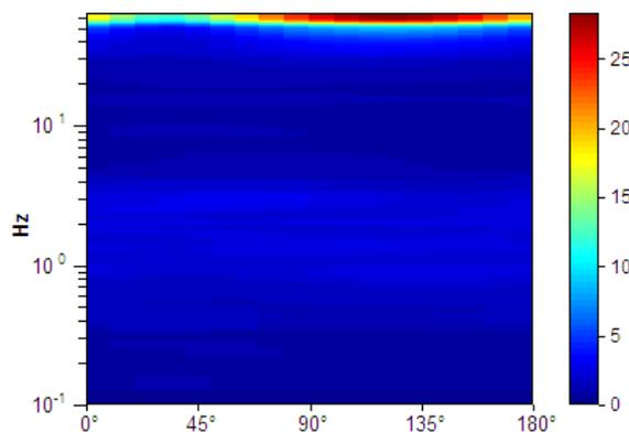
**Picco H/V a  $1.34 \pm 0.38$  Hz (nell'intervallo 0.0 - 20.0 Hz).**
